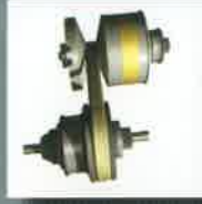
Lassú fokozat: A sebesség csökkentése variotárcsás váltó segítségével
